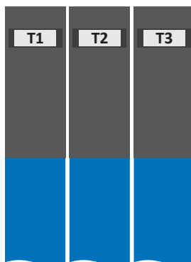
Fig. 19: Champs sur la face avant de l'appareil pour l'identification
