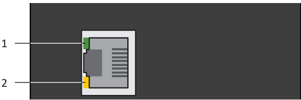
Fig. 68: Diodes électroluminescentes indiquant l'état de la connexion au réseau de maintenance
