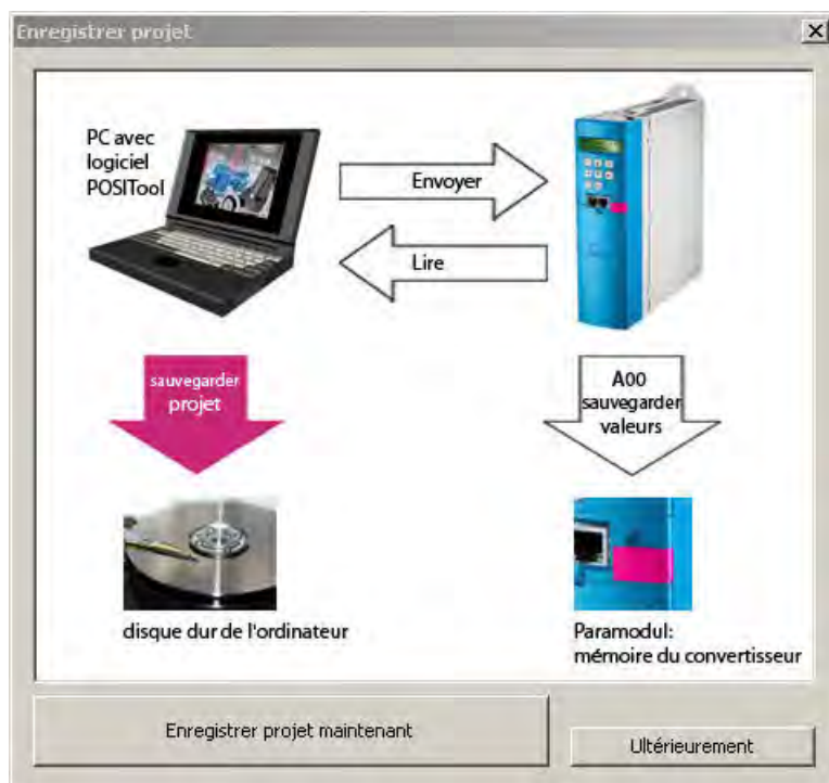
Fig. 11-5 liaison en ligne établie
