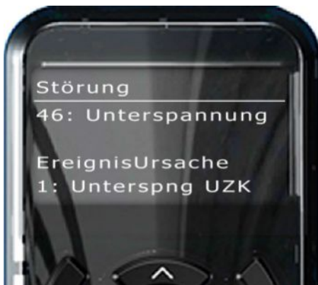
Abb. 97: Anzeige einer Störung am Display
