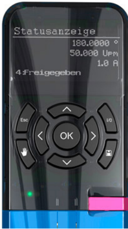
Abb. 67: Bedieneinheit des Antriebsreglers SD6
