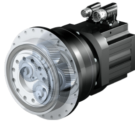
行星齿轮减速电机 PH、PHQ、PHV 加速力矩：60 - 43000 Nm 齿隙：1 - 4 弧分 Quattro Power 打造出色的功率密度。
