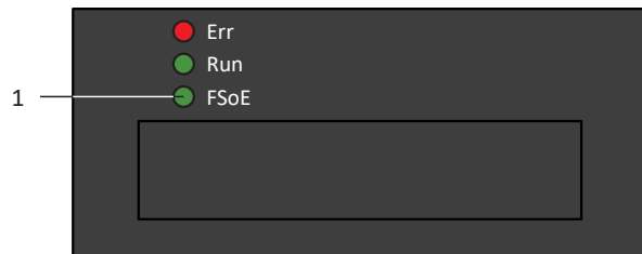
Abb. 7: Leuchtdiode für den FSoE-Zustand
