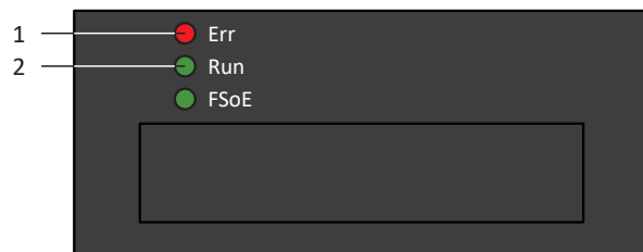
Abb. 6: Leuchtdioden für den EtherCAT-Zustand
