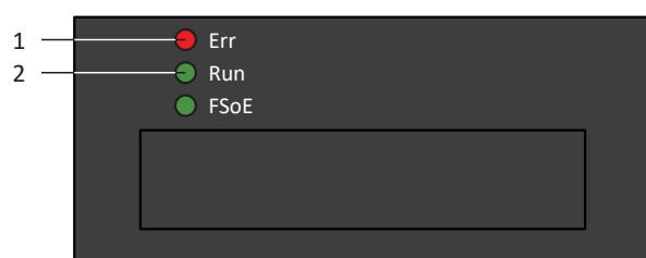
Fig. 6: DEL indiquant l'état EtherCAT
