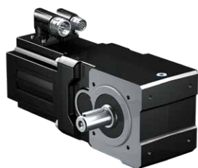
Motoriduttore coppia conica KL Coppia di accelerazione: 10–65 Nm Gioco torsionale: 16–25 arcmin Forma piacevole. Dinamico. Completamente senza deviazione dell'asse.
