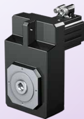
Motoriduttore pendolare F Coppia di accelerazione: 21–1100 Nm Gioco torsionale: 5–11 arcmin Alta precisione di posizionamento e stabilità al gioco.
