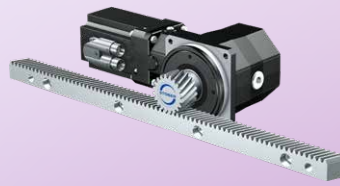
Azionamento a cremagliera con servomotore sincrono ZVKS Modulo: 2–4 mm Forza di avanzamento: 1,3–11 kN Velocità di avanzamento: 0,08–3 m/s Grande flessibilità per l'automazione e la robotica.
