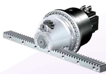
Azionamenti a cremagliera con servomotori sincroni ZTRSPH(Q), ZTRSPHV Modulo: 2–8 mm Forza di avanzamento: 2,8–124 kN Velocità di avanzamento: 0,09–4 m/s Grande forza di avanzamento per la massima densità di potenza.
